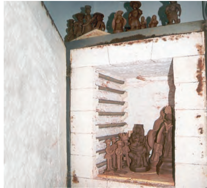
Mufia elétrica onde as Figuras são cozidas a cerca de 900C°.
