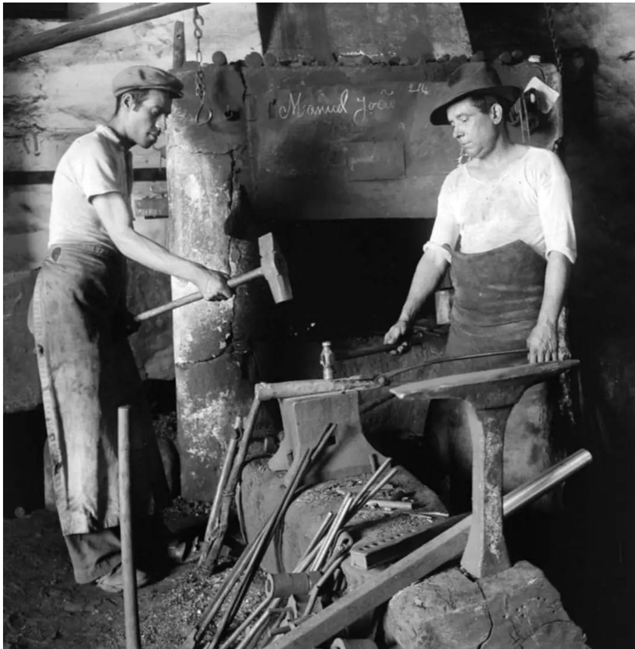
Anexo 1: Manuel João Alves Fragoso (à direita) a orientar o processo de bater o ferro quente. Fotografia de Artur Pastor (década de 1950)
