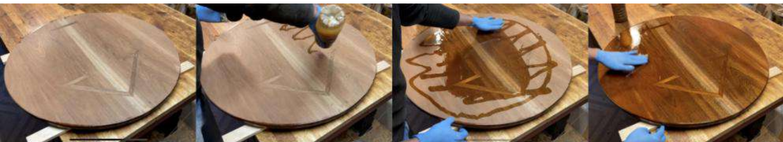
Fig. 41: Acima o passo-a-passo do acabamento com a mistura na Mesa Seta.
