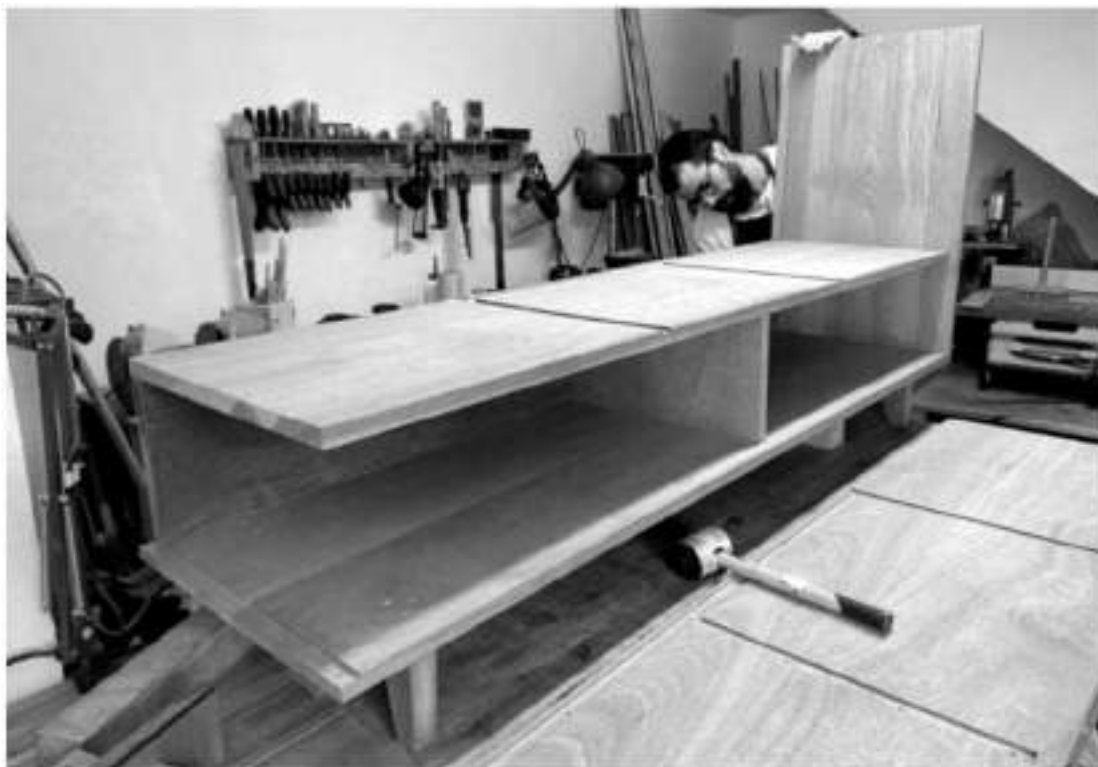
Fig. 40: A montagem do Aparador (D+F).
